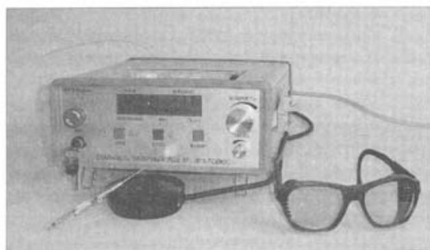
Рис. 2. Лазерный скальпель «ЛС-0,97-ИРЭ-Полюс»
